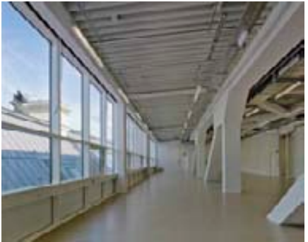
Für die Restaurierung der Gemälde sind vor allem die nach Norden ausgerichteten Werkstattbereiche vorgesehen. Im Innenraum wurde auf möglichst neutrale Farben geachtet, um Verfärbungen auf den Gemälden zu vermeiden. Auf der Südseite wurde eine Sonnenschutzeinrichtung eingebaut, die die äußeren Einflüsse neutralisieren kann.
