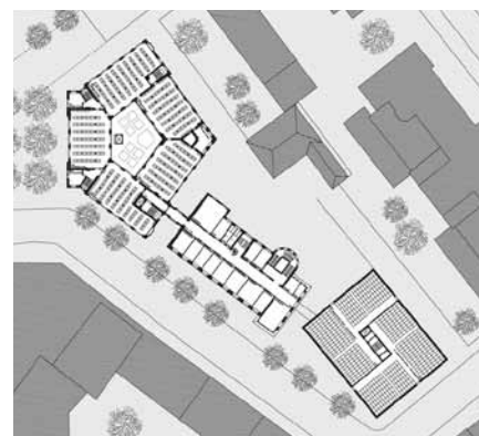
Wettbewerbsentwurf, Grundriss des 1. Obergeschosses mit Archivetagen in den Magazinen
