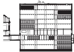
Längsschnitt Magazinneubau mit Anschluss an das Verwaltungsgebäude
