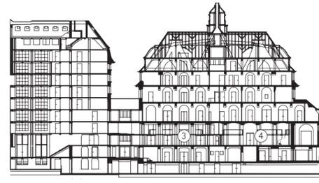
Längsschnitt Verwaltungsgebäude mit Anschluss an den Magazinltbau
