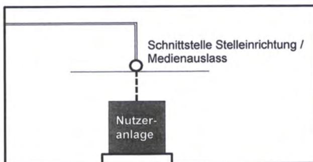
Die Stelleinrichtung bzw. der Medienauslass soll möglichst in unmittelbare Nähe der Nutzeranlage herangeführt werden. Planung und Bauausführung bis einschließlich Schnittstelle erfolgen durch die Bauseite und werden im Bauhaushalt abgebildet.
